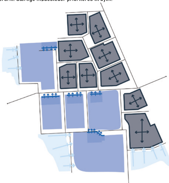
Byg til kanten – Gaderummene understøttes ved at bygge til kant – forskelligt i de forskellige typologier
