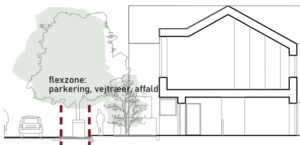
Principudsnit for placering af affald - Ovenfor vises eksempel på hvor og hvordan affald håndteres i bebyggelsen. I vejtracéet på bolig-gaderne og Kløvereng er afsat plads til en flexzone med varierende program. Her kan placeres parkering, nedgravet affaldsløsning og vejtræer.
