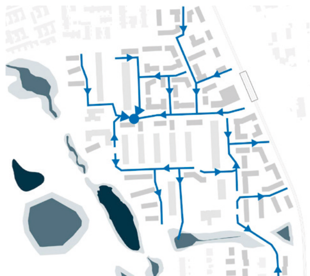
Skybrudsregn - Skybrudsregn opstaves langs veje og ledes i reasebassinerne. ■ Opstuvning - 100 årshændelse ● Rørføring → Opstuvning på veje
