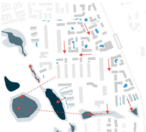
Hverdagsregn - Vand opsamles i gårdrum og langs gader og ledes til reasebassiner ■ Eks. søer, mose, vandløb, bassiner ■ Reasebassiner - 1 års hændelse ■ Opstuvning - 5 års hændelse → Strømningsveje - - - Strømningsveje, underjordiske
