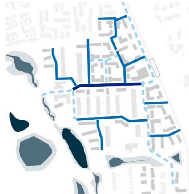
Vandhåndtering - håndteres synligt på overfladen, men enkelte steder er gader rørførte Synlig vandhåndtering Rørførte gader Opsamlingsgade
