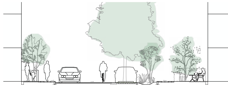
Principssnit- 1:200 - Forsinkelse af hverdagsregn i et regnbed
