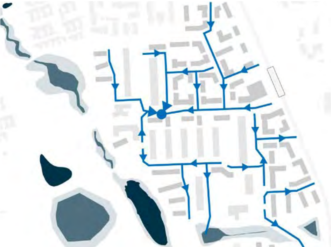
Principssnit- 1:200 - Ekstremregn forsinkes i en grøft for den ledes til Vollsmoserenden
