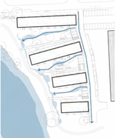
Regnvandshåndtering Vand skal håndteres og forsinkes i åbne render indenfor grunden inden det ledes ud til de større vandrender langs vejene. Ved større mængder regn forsinkes vandet i en lavning på 20-25cm inde i gårdrummet Vandhåndteringen løses synligt på terrænen, med rekreative elementer i lavningen, tilsvarende krav til både vandhåndtering og fælles opholdsareal.
