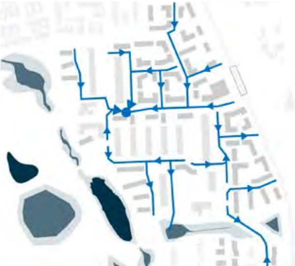
Skybrudsregn - Skybrudsregn opstuvnes langs veje og ledes i rensebassinerne. Opstuvning - 100 årshændelse Opstuvning på veje Strømningsveje Rørføring
