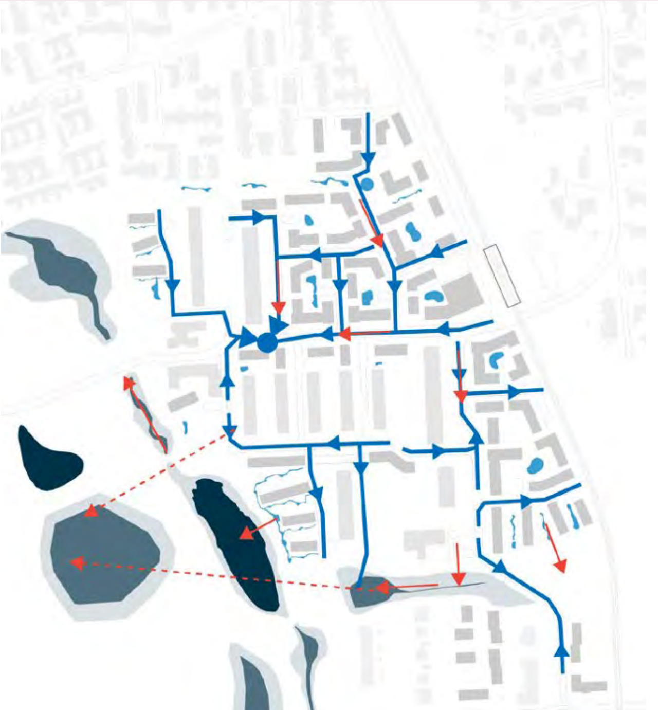
Grundprincipper - Med udgangspunkt i grundprincipperne fra bydelens plan skabes synlig vandhåndtering med rummelige kvaliteter, der skaber nysgerrighed og leg og gør vandet til et attraktivt element både langs bygaden og i boliggederne.
