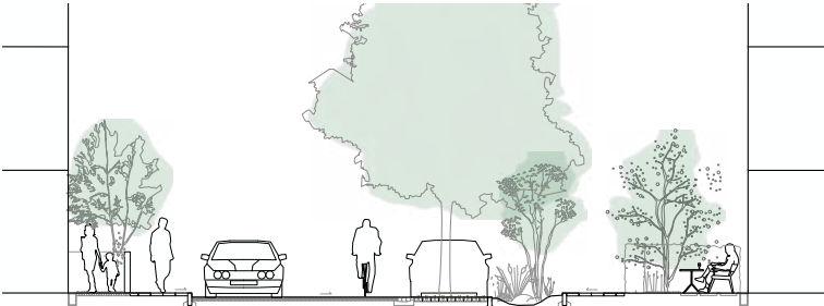
Principssnit- 1:200 - Forsinkelse af hverdagsregn i et regnbed
